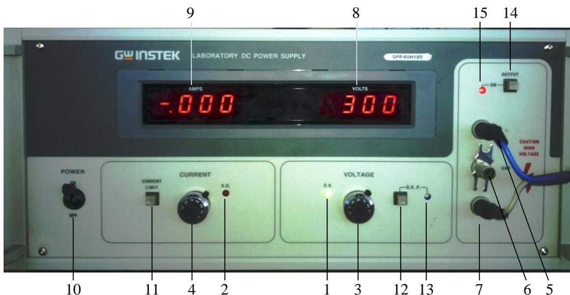
Рис. П2. Передняя панель источника питания GPR-60H15
