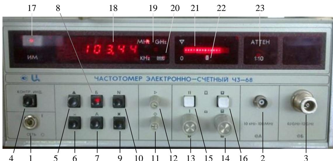
Рис. П4. Передняя панель частотомера ЧЗ-68
