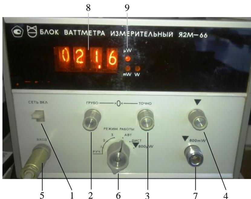
Рис. ПЗ. Передняя панель измерительного блока Я2М-66
